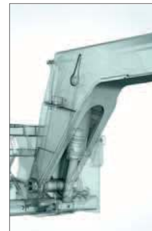
Встроенный выступ стрелы и монолитная закрывающая пластина
